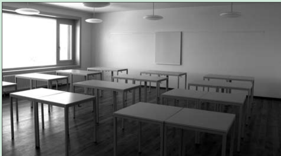
Classes sobres au sol habillé par du parquet en chêne massif suisse (2 e qualité) afin de soutenir l'industrie nationale du bois. Le bâtiment répond aux critères d'économie d'énergie du label Minergie.
